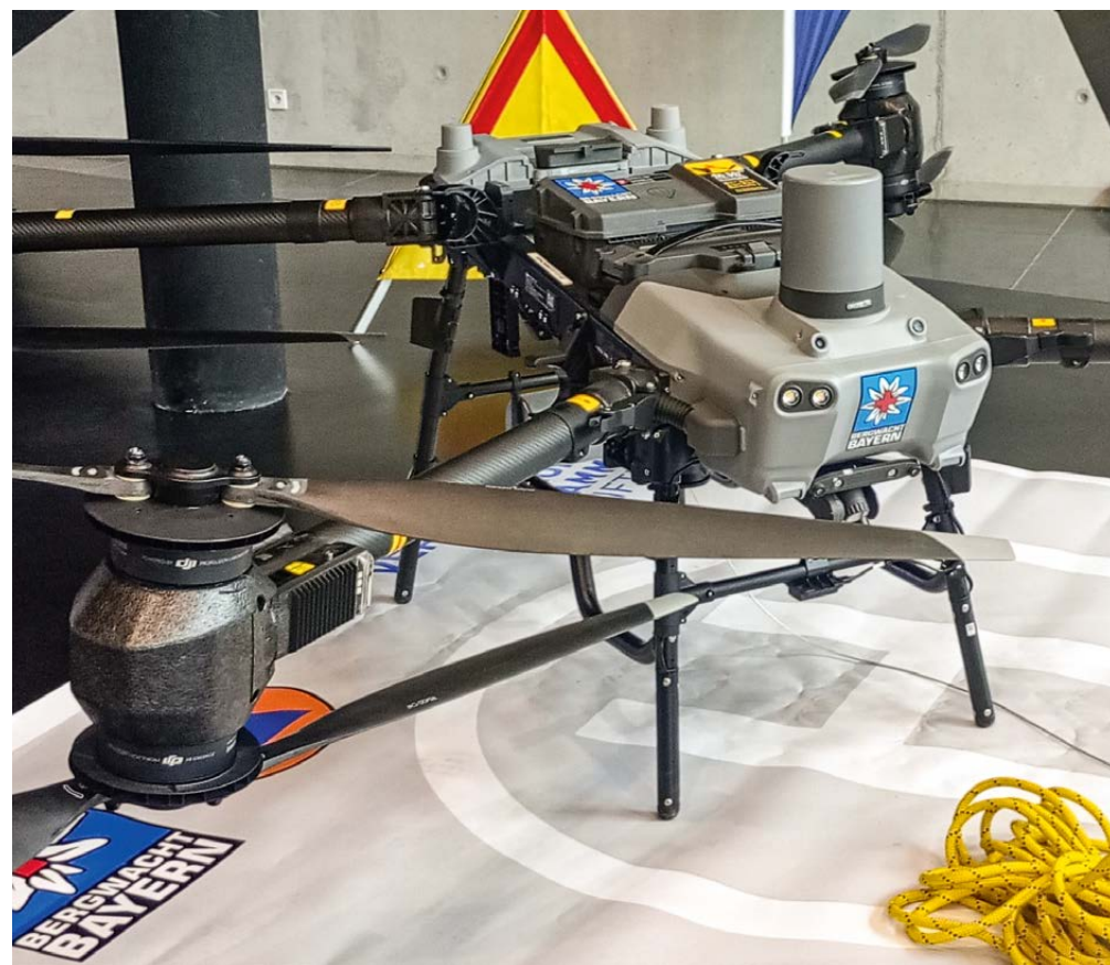
Die Lastendrohne „Carry“ der Bergwacht Bayern kann rasch notwendiges Material an den Unfallort transportieren.
