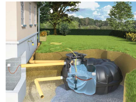
Eine Regenwassernutzungsanlage im Garten kombiniert die Rückhaltung von Wasser zur Entlastung der Kanalisation mit der anschließenden privaten Nutzung, beispielsweise für die Pflanzenbewässerung (L.). Einbau eines Regenrinnensystems im Zuge einer Straßensanierung (M.). Einbau von Blockrigolen als Versickerungs- und Rückhalteanlage von Oberflächenwasser im städtischen Raum (r.).
